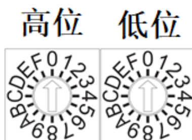
图 3-38 旋转编码开关说明
