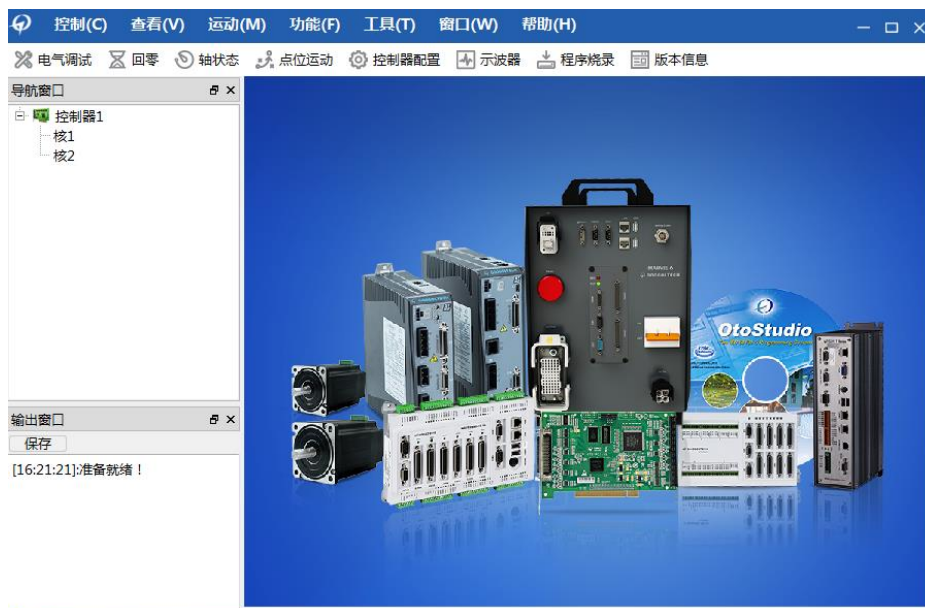
图 2-3 打开 MotionStudio 出现此界面表示运动控制器通讯正常
